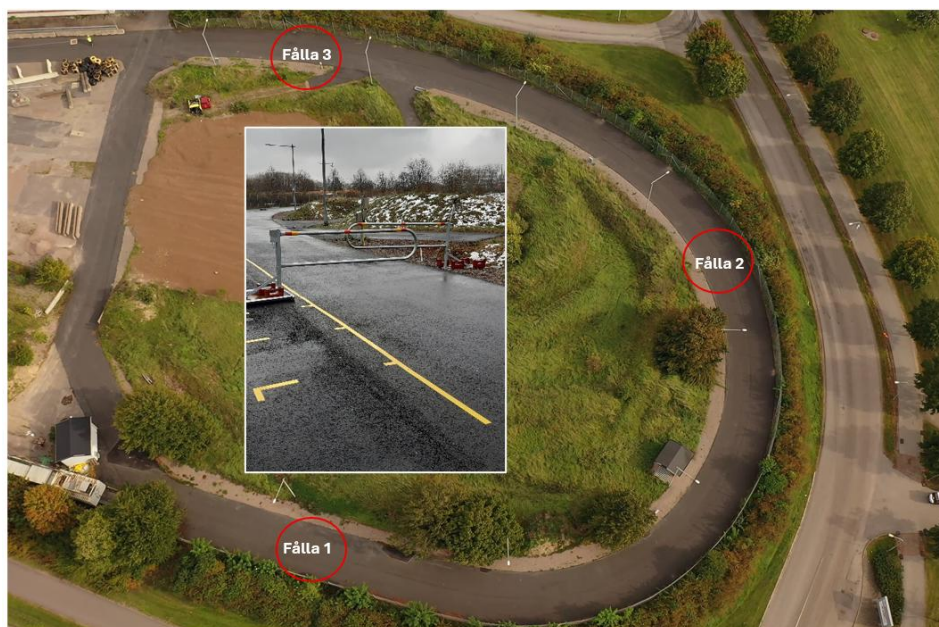
Figur 12 Vy över VTI:s cykeltestbana (foto: AILAB@LiU), där fällornas placering är utmarkerade. Den infällda bilden visar fälla 3 i riktning mot fälla 2 (foto: Jenny Eriksson). Tre kameror satt placerade i lyktstolparna som fångade cyklisternas rörelse och hastighet.
